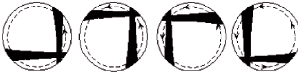
Figure 4 : Déplacement du centre de la croix noire au cours de la rotation de la platine du microscope dans le cas d'une figure d'interférence uniaxe décentrée
